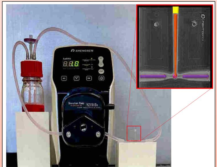
**Figure 4 : Le système fluide du bioréacteur biomimétique** composé d'une pompe péristaltique, d'un flacon permettant les échanges gazeux et du bioréacteur transparent imprimé en 3D. Jaune = bouchon, Orange = biomatériau conique, Rose = DPSCs dans un gel collagénique (réservoir cellulaire), Violet = circulation du milieu de culture
